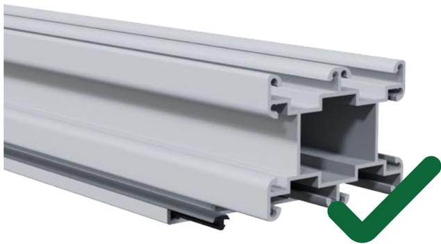
Es ist zu beachten, dass sich die verwendeten Dichtungen nach dem Einbau im Profilkanal zusammenziehen. Wir empfehlen, die Dichtungen beidseitig mit einer Überlänge von mindestens 25 mm zu montieren und nachdem sich die Dichtungen gesetzt haben bündig mit dem Profilkanal abzuschneiden. Bei Dichtungen mit Sonderlängen weisen wir in der Montageanleitung darauf hin. Bei den Dichtungen sind Stückelungen zulässig.
